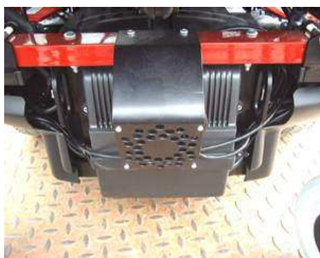
Système de ventilation (cliquez pour agrandir)
