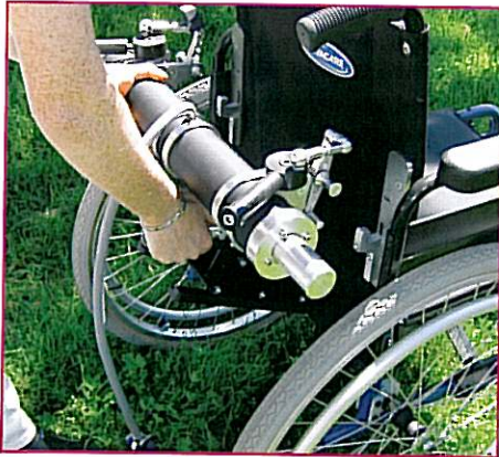
Poser la motorisation sur les crochets du fauteuil. Poids 7 kg. Puissance des moteurs 2 x 100 w.
