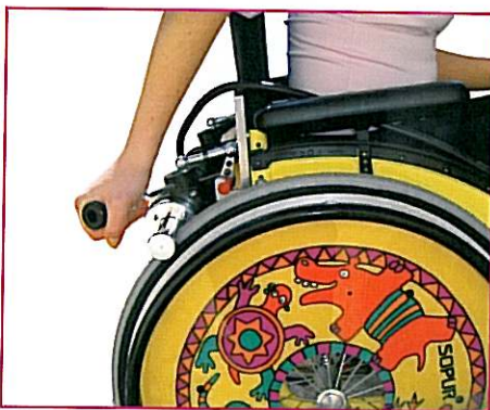
2 moteurs entraînent directement les roues. Il est possible de débrayer et de rouler librement. Vitesse maxi 10 km/h. Franchissement 20% pour une personne de 70 kg.
