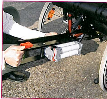
Glisser le rack batterie sur le support. La connexion est automatique.
