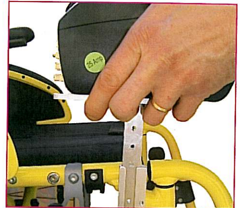
Mettre en place la commande correspondante sur la glissière installée sur votre fauteuil.
