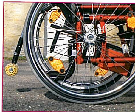
L'équilibre initial du fauteuil est conservé car les batteries sont sous l'assise en avant de l'axe des grandes roues. Un stabilisateur amovible assure la sécurité en toute circonstance.
