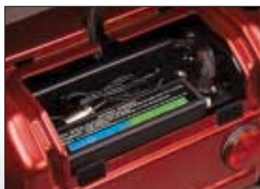
▲ Jeux de 2 batteries au plomb 12 volts 50 Ah rechargeables.
