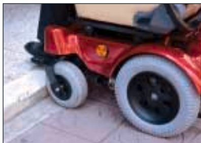
▲ Dimension des roues avant et arrière pour une stabilité maximale lors du franchissement des obstacles et plans inclinés.
