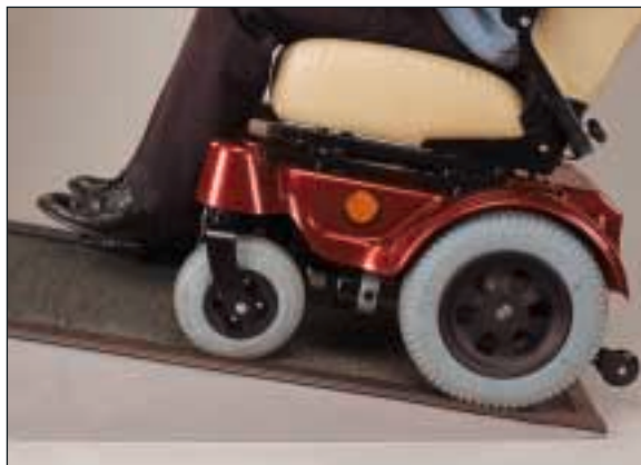
▲ Monté d'un plan incliné à 8°, sécurisé par les roulettes anti-basculé à l'arrière
