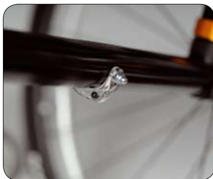
Aide visuelle pour un alignement optimal (pincement positif / négatif).
