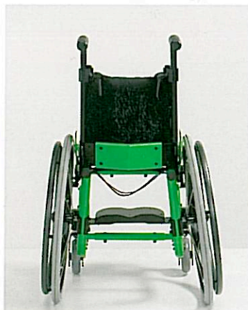
L'inclinaison des roues augmente la stabilité
