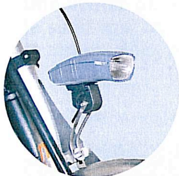
Eclairage sur batteries
