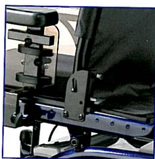
Profondeur de l'assise 29 cm, réglable 29 - 47 cm. Réglage en hauteur de l'assise sur 3 niveaux (45, 48 et 50 cm)
