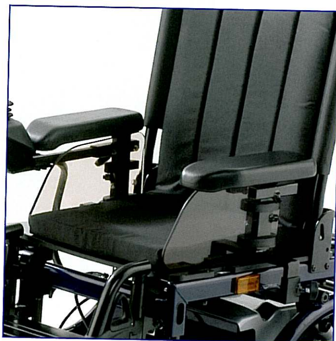
Accoudoirs Junior pour largeur d'assise 30-36 cm, amovibles, réglables en hauteur avec effet mémoire Dossier réglable mécaniquement à 30° par paliers de 3,5 cm pour profondeur d'assise 29-47 cm (poids max. de l'utilisateur 100 kg) Dossier réglable électriquement à 30°, également possible avec profondeurs d'assise 29, 33 et 36 cm
