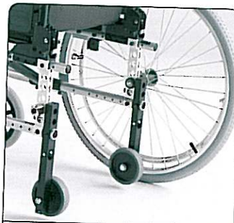
Kit de transfert En ôtant les roues arrière, la largeur hors tout du fauteuil correspond à la largeur d'assise + 15 cm.
